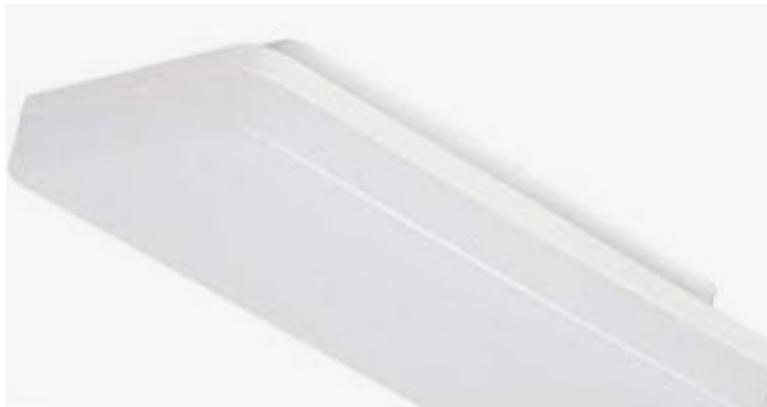
Plafoniera lampada led 4x 4000K 4900 lm potenza 43 w per installazione a soffitto o a sospensione. Prodotto in conformità alle norme EN 60598 CEI 34-21, classe di isolamento I e grado di protezione IP20 - IK07 in conformità alle norme EN 60529 e EN 50102. Corpo in acciaio zincato preverniciato con resina poliestere ottica ad alveoli a doppia parabolicità antiriflesso in alluminio speculare a bassissima luminanza
